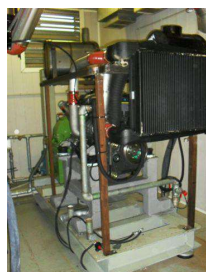
Motore al banco prova
